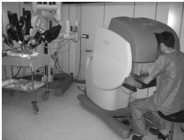
Fig. 1 – Télém manipulateur Da Vinci S. À droite, la console permettant à l'opérateur de contrôler les bras articulés du chariot mobile situé à gauche. Les mains de l'opérateur contrôlent les mouvements des bras du chariot mobile par le biais des manettes reliées aux instruments chirurgicaux par des circuits électroniques transmis par des servomoteurs.
